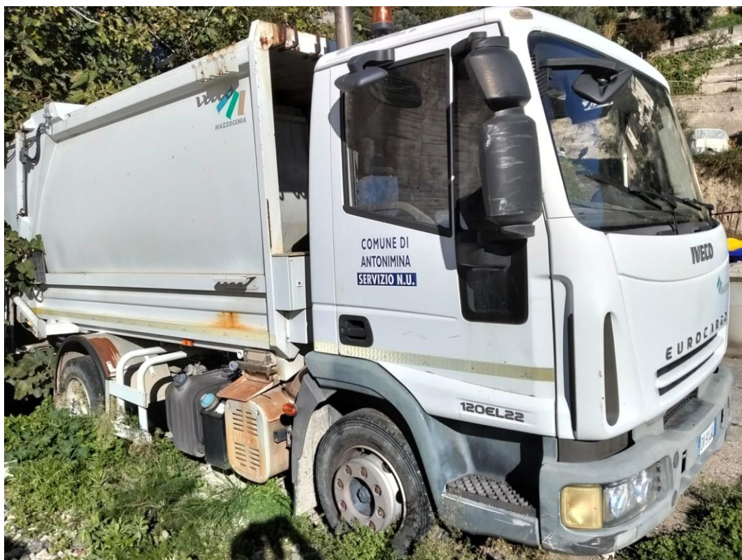
Foto 2 – Vista laterale della vasca compattatrice Mazzocchia e del gruppo di caricamento posteriore
